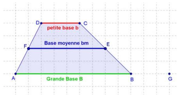
En fait, il faut d'abord déterminer la base moyenne dont la longueur est la moyenne arithmétique des deux bases du trapèze : **Base moyenne** =  $b_m = \frac{B+b}{2}$
